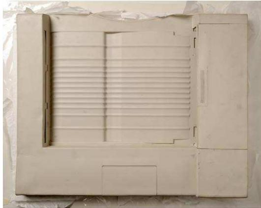
L'elemento 3 (Carrello carta A) e il 4 (Carrello carta B), hanno forma e struttura molto simile, costituiti da più porzioni assemblati con la medesima tecnica, ma privi di una struttura interna di sostegno o di riempimento e dunque parzialmente vuoti.
